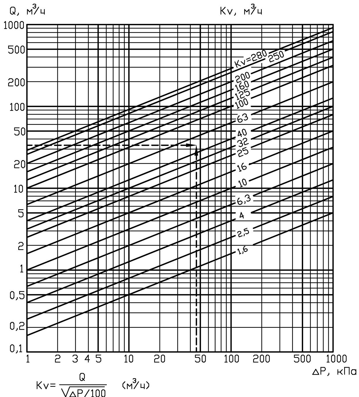
$Q$  – расчетный расход воды через регулятор, м<sup>3</sup>/ч.
