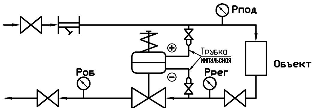
**Схема подключения регулятора давления "после себя"**
