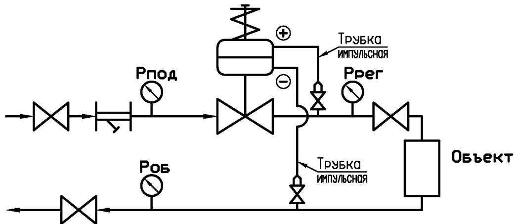
**Схема подключения регулятора перепада давления
