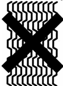
Рисунок Б.3 – Вид пакета пластин при неправильной сборке
