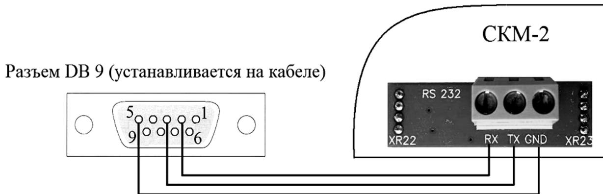
Рисунок Г.5 – Схема подключения счетчика к компьютеру
