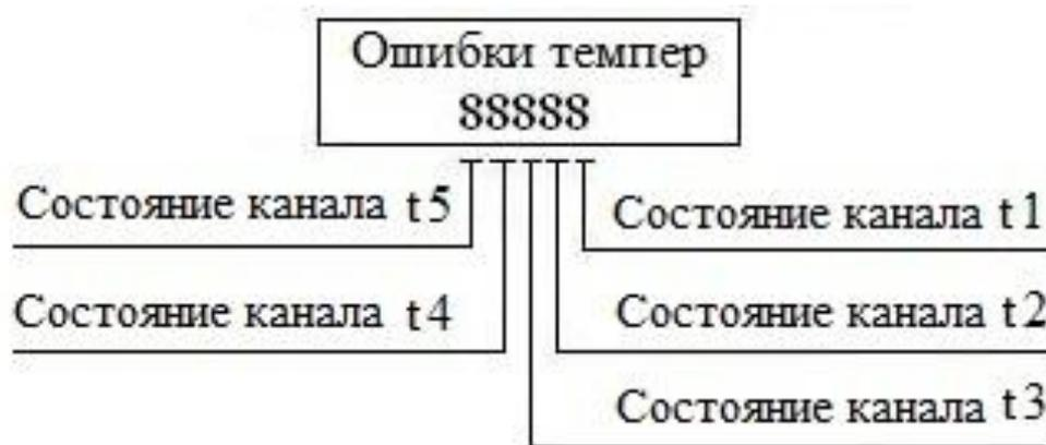
Рисунок 6 – Окно состояния каналов температуры
